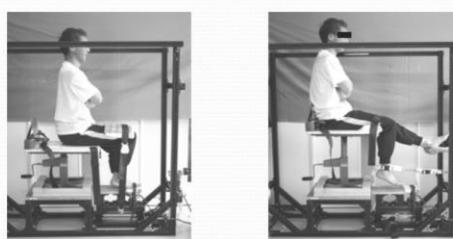
筋力の測定風景(左:底屈力、右:膝屈曲力)
